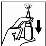
Vor der ersten Anwendung mehrmals pumpen, bis ein gleichmäßiger Sprühnebel austritt. Bei allen weiteren Anwendungen ist das Dosierspray sofort gebrauchsfertig.
